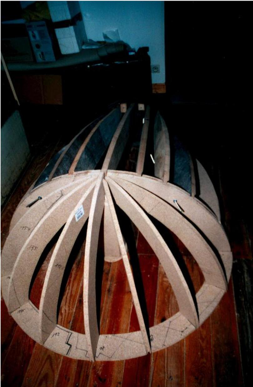
Der hintere Teil des Modells bleibt erhalten, allerdings wurde der Auflagespant verstärkt
