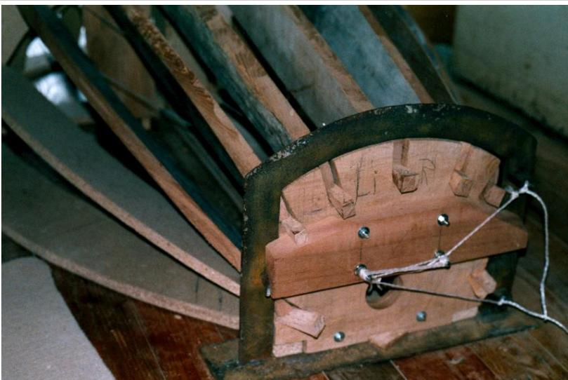
Der vordere Teil. Damit beim Ausbau nichts passieren kann, werden die einzelnen Spante in ihren Arretierungs-Nuten gekeilt. Aus heutiger Sicht unnötig: Bei Herausnahme der Vorder-Platte fallen die Spante herunter bzw. lassen sich leicht in die Mitte bewegen.
