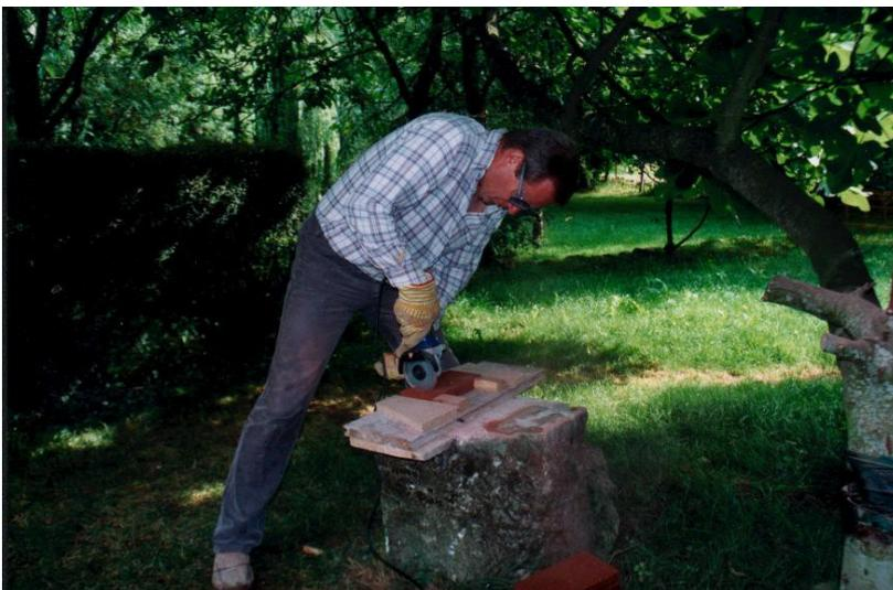
Die Ziegel, 3 cm dick werden mit einer Trennscheibe von Hand geschnitten. Die Platten sind an den Ecken fest eingefaßt. Die Unterlage selber ist auf dem „Tisch“ gegen Verschiebung gesichert. Empfohlen wird dieses nicht ganz ungefährliche Verfahren nicht. Besser und weit ungefährlicher sind fest zu installierende Schneidemaschinen
